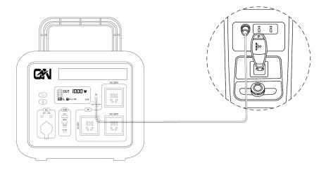
可使用汽车上的车充口对本产品进行充电,需在汽车点火启动后使用车充充电,以免造成汽车电瓶亏电无法启动。同时确保汽车车充口和车充输入线的点烟器接触良好。若因不按规范操作而造成损失,本公司不予承担相应责任。
